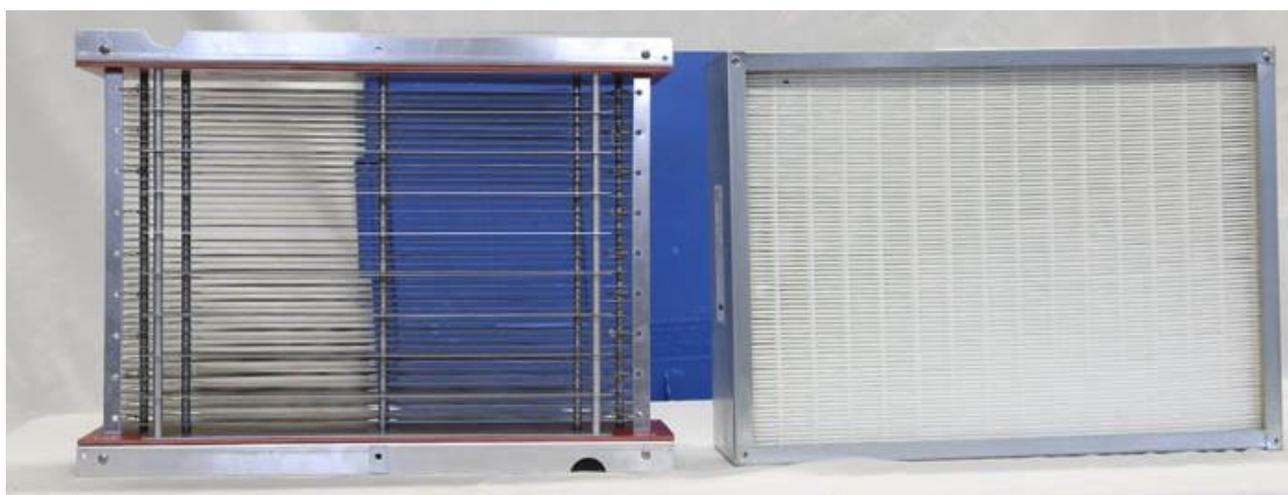
La foto mostra il Filtro Elettrostatico a fianco del filtro HEPA. Da notare quanta aria può passare liberamente attraverso il filtro Elettrostatico VS il filtro HEPA. Il filtro HEPA produce 22% di perdite di carico, mentre il filtro Elettrostatico solamente 4%.
